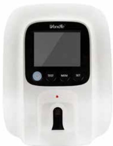
Полуавтоматический анализатор, который применяется в комплексной диагностике нарушений свертывания крови. Предназначен для количественного определения параметров коагуляции цитратной венозной цельной крови:
